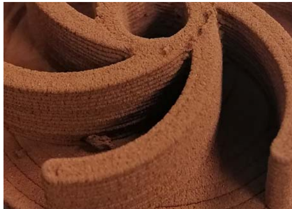
Zoom d'una peça en verd impresa amb coure reciclat
